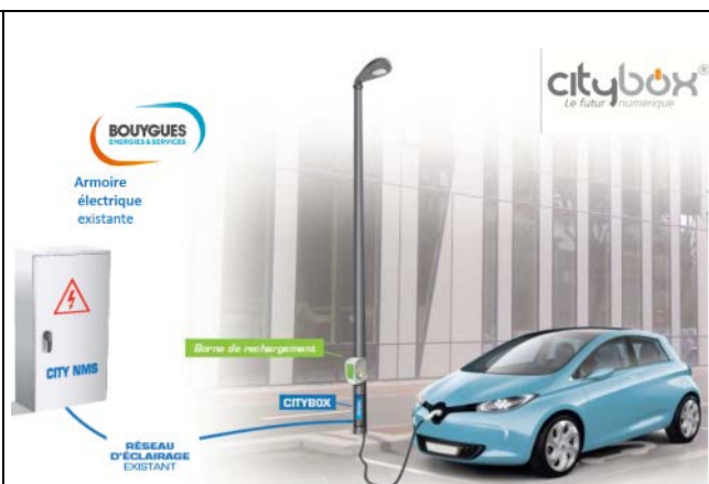
Figure 9 – Installation de bornes de recharge sur un candélabre (Source : Bouygues Énergie et Services)
