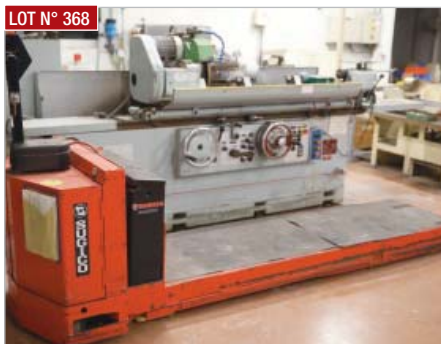
► Transpalette électrique SUGICO, LW2-35L-2 , capacité 3 T, plateau de 3 m ► SUGICO electric pallet truck, LW2-35L-2 , capacity 3 T, platform 3 m
