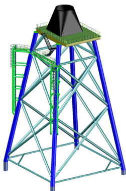
Jacket pour éolienne offshore (STX France Solutions)
